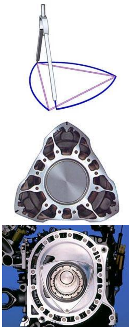
Рис. 3.152. Форма ротора и статора роторного двигателя
