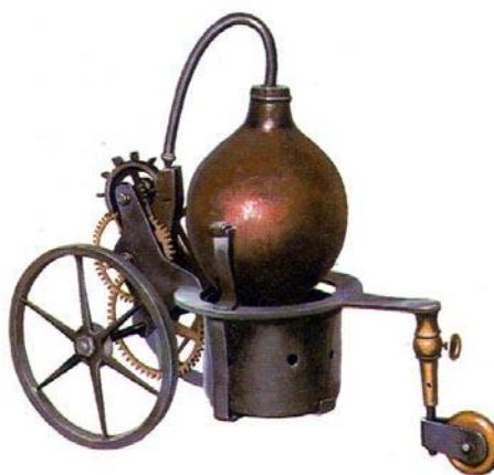
Рис. 3.34. Паровая турбина на колёсах
