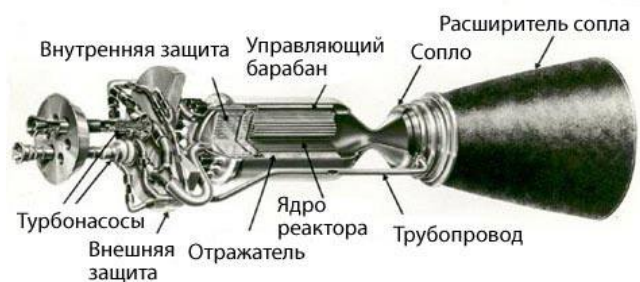
Рис. 3.163. Схема ядерного ракетного двигателя
